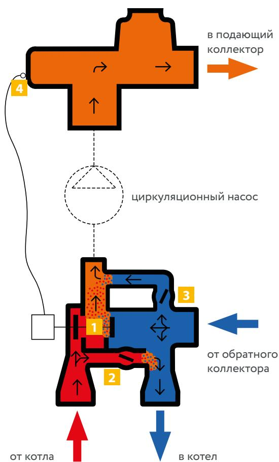
Смесительный узел IWS состоит из двух частей – непосредственно насосно-смесительной части и байпаса с перепускным клапаном избыточного давления.
