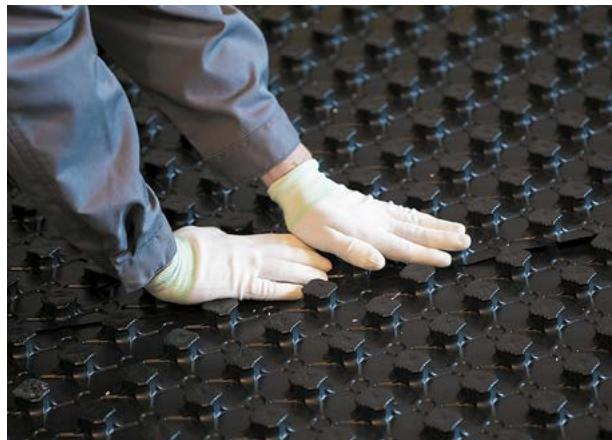
Полистирольное покрытие предотвращает попадание бетона и влаги стяжки в теплоизоляционные маты, что позволяет избежать разрушения теплоизоляционного слоя. Кроме этого, данное покрытие не сминается при ходьбе по нему и надежно защищает трубу во время монтажа и заливки стяжки.
