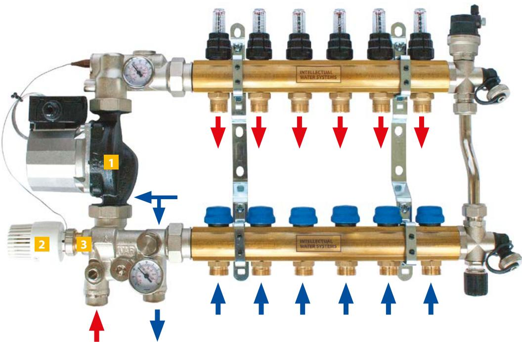
Циркуляционный насос 1 обеспечивает циркуляцию теплоносителя через петли теплого пола. При остывании теплоносителя ниже настроенной температуры термоголовки 2, смесительный клапан 3 открывается и обеспечивает подпитка вторичного контура теплоносителем из первичного контура с подмесом теплоносителя из подающего коллектора вторичного контура.
