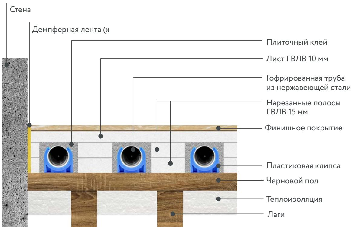
1. По всему периметру помещения, без пропусков, укладывается **демпферная лента**. Для повышения удобства и уменьшения времени монтажа демпферная лента IWS имеет клеевой слой по всей площади одной из сторон ленты.
