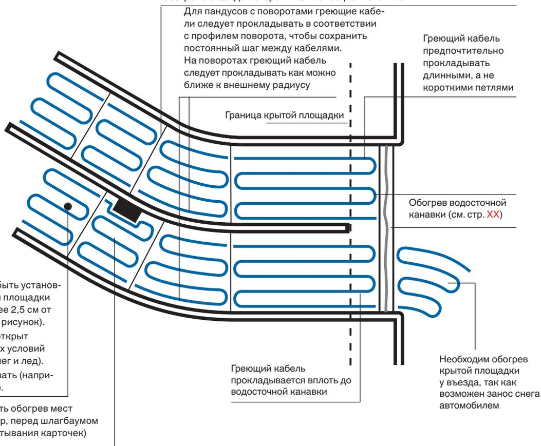
Датчик температуры земли и влаги может быть установлен вне обогреваемой площадки на расстоянии не менее 2,5 см от греющих кабелей (см. рисунок). Датчик должен быть открыт воздействию погодных условий (дождь, снег, талый снег и лед). Датчик нельзя закрывать (например, при чистке снега).
